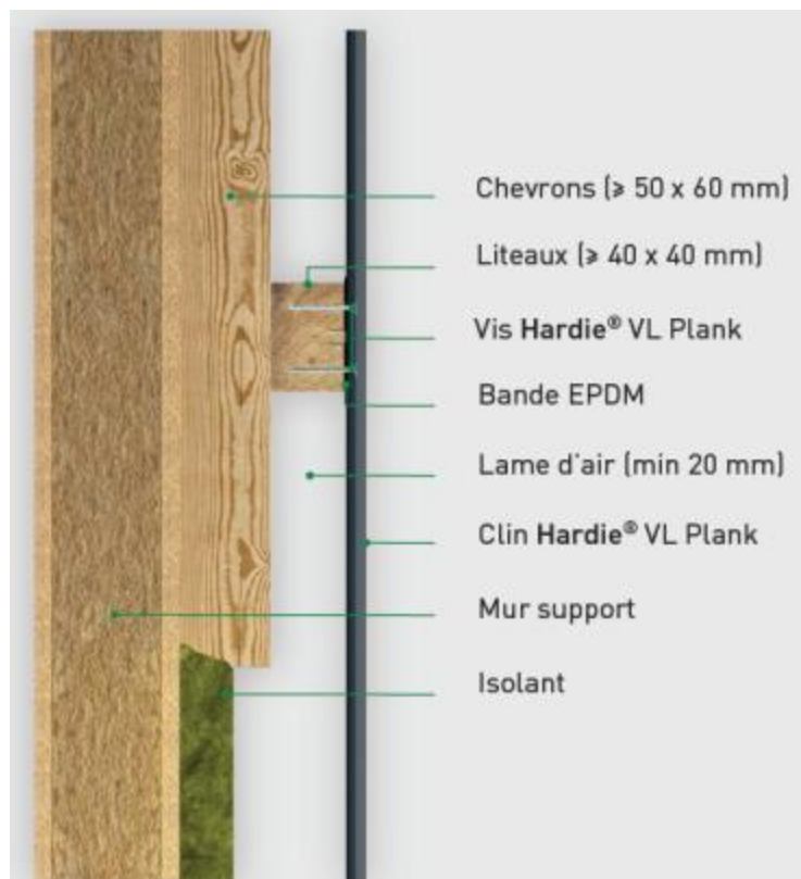
Figure 38 - Coupe sur COB coupe verticale (pose verticale des clins)
