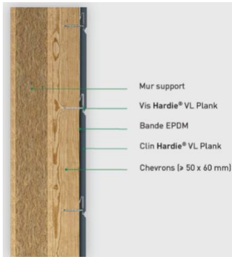
Figure 37 - Coupe sur COB coupe verticale (pose horizontale des clins)
